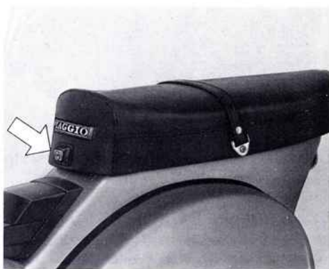
Fig. 5 - Ribaltamento sella per accesso al tappo serbatoio.
