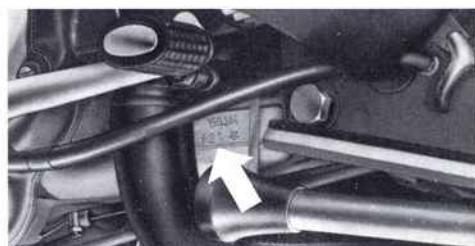
Fig. 4 - Esempio di stampigliatura sul motore
